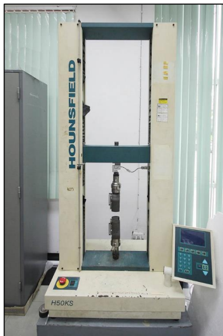
เครื่องทดสอบแรงดึง (UTM Houndfield : 50 KN)
