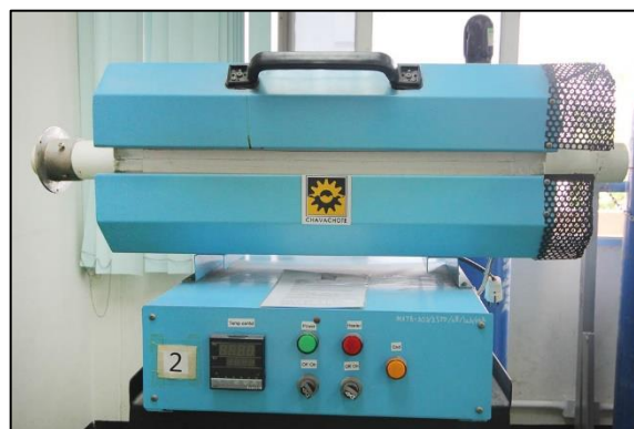
เตาท่ออุณหภูมิสูง Tube Furnace 1200 °C (Chavachote 2)
