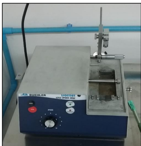
เครื่องตัดความเร็วต่ำ (Low speed cutter)
