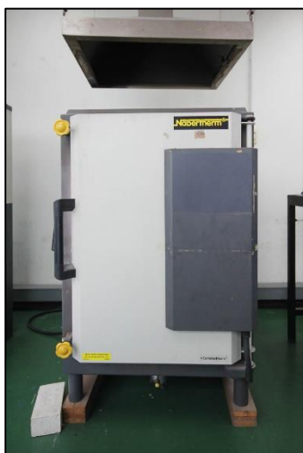
เตาเผาอุณหภูมิสูง Muffle furnace 1400 °C (Nebertherm)
