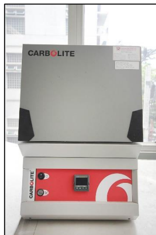
เตาเผาอุณหภูมิสูง Muffle Furnace 1300 °C (Carbolite)
