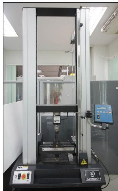
เครื่องทดสอบแรงดึง (UTM, Cometech : 10 KN)
