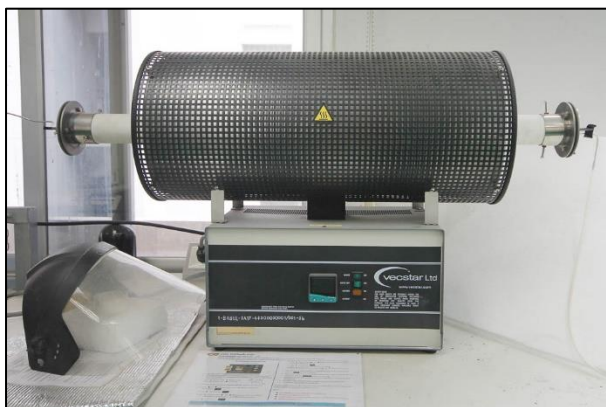
เตาท่ออุณหภูมิสูง Tube Furnace 1150 °C (Vecstar)
