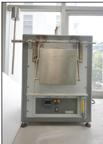
เตาเผาอุณหภูมิสูง Muffle Furnace 1300 °C (Modul Temp)
