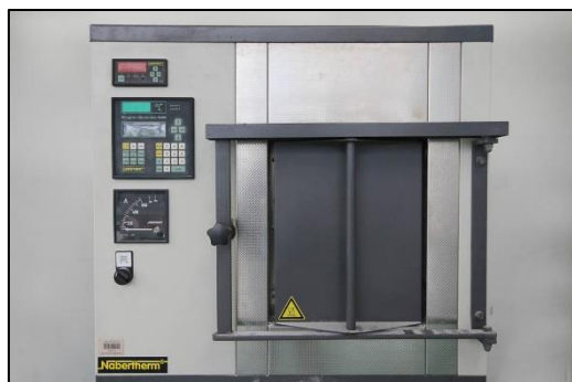
เตาเผาอุณหภูมิสูง Muffle furnace 1800 °C (Nebertherm)
