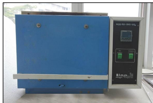
เตาเผาอุณหภูมิสูง Muffle Furnace 1200 °C (Linn)
