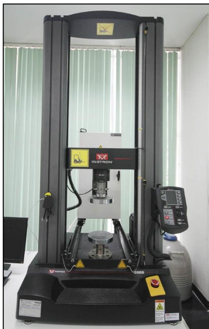
เครื่องทดสอบแรงดึง (Instron 50 KN)
