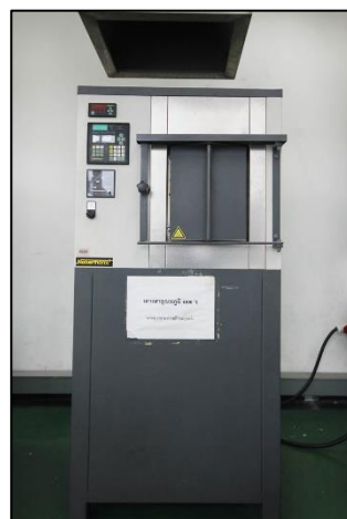
เตาเผาอุณหภูมิสูง Muffle furnace 1700 °C (Nebertherm)
